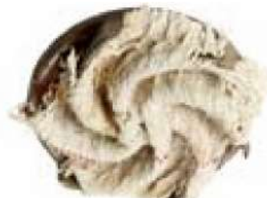
Figura D: Accumulo in una girante a vortice
