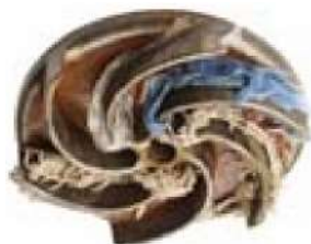
Figura C: Accumulo in una girante a vortice
